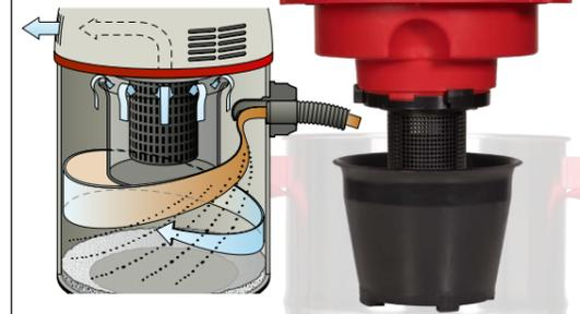
Grâce au tourbillon créé par le tube d'admission, la brume de pulvérisation est séparée la paroi du récipient. Des matériaux filtrants ne sont plus nécessaires. Interruption automatique par flotteur, également lors de la formation de mousse. Des fentes d'aération latérales veillent à une séparation conséquente d'air de refroidissement et d'air de processus.
