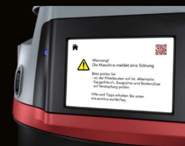
L'écran tactile interactif affiche les temps de fonctionnement, les défauts, la maintenance, la date et l'heure. Le réglage de l'écran de démarrage est personnalisable. Par exemple, les données sur l'appareil et l'utilisateur peuvent être importées et affichées en permanence.
