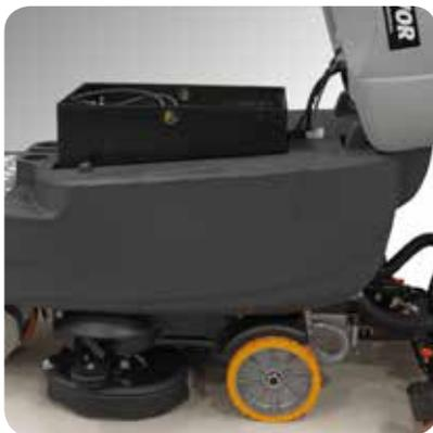
disjoncteurs thermiques. 80 kg de pression continue du plateau des brosses avec un système auto-stabilisateur, pour retirer efficacement tout type de saleté de tous les sols. Roues robustes en polyuréthane résistant aux huiles. Logement batteries pour des batteries de 500 Ah C5 qui permettent des temps de travail en continu, jusqu'à 5 heures.
