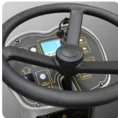
Un nouveau panneau de commande avec des commandes et des affichages digitaux. Affichage digital: compteur d'heures, indicateur de niveau de charge des batteries, indicateur du niveau bas du réservoir, indicateur de marche avant/arrière. Réglage de la vitesse,
