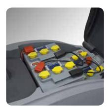
Accès rapide au logement des batteries et du moteur d'aspiration sans outils. Réservoirs en polythène ayant une grande résistance aux chocs et aux acides, et ayant une grande capacité (88 l), évitant les arrêts fréquents pour le remplissage. 4 batteries x 6 V - 180 Ah C5 qui garantissent une grande
